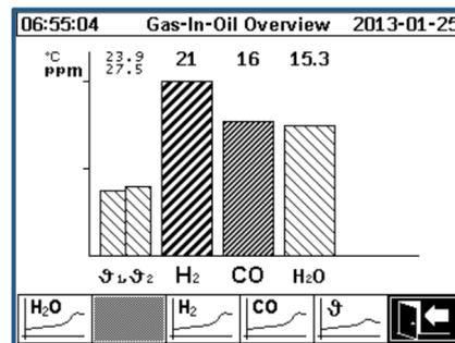
Histogramme individuel pour l'Hydrogène (H<sub>2</sub>), le Monoxyde de Carbone (CO) et l'humidité dans l'huile (H<sub>2</sub>O) et les Températures.
